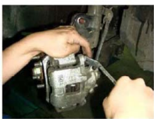
2 拆下煞車分泵固定螺絲
