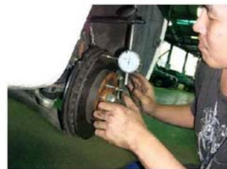
6 量測碟盤偏擺度
