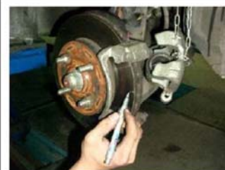
7. 碟盤厚度量測點記號
