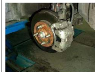
12. 完成碟式煞車檢修
