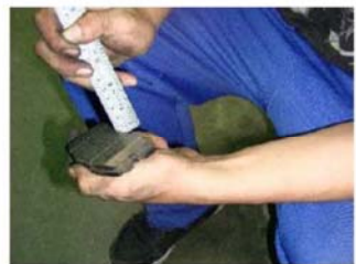
4 量測煞車塊厚度
