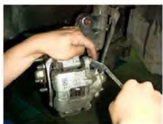
2 拆下煞車分泵固定螺絲
