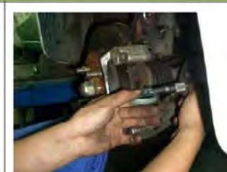
9. 測量碟盤厚度
