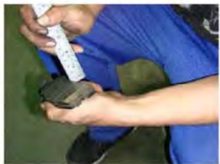
4 量測煞車塊厚度
