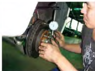
6 量測碟盤偏擺度
