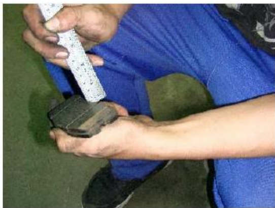
4 量測煞車塊厚度
