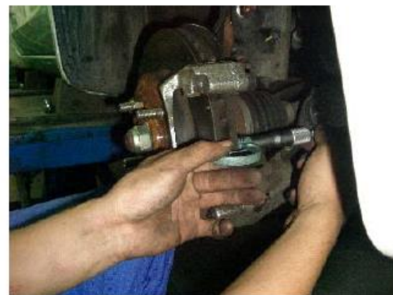
9. 測量碟盤厚度
