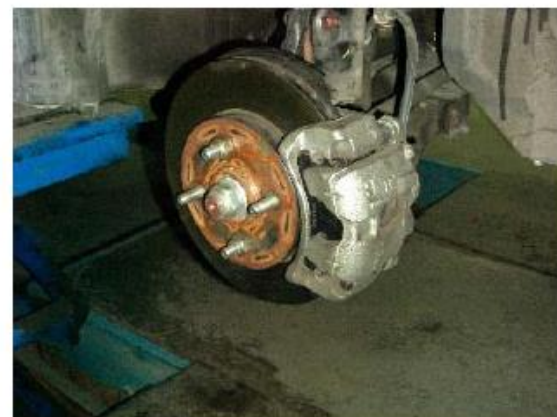
12. 完成碟式煞車檢修
