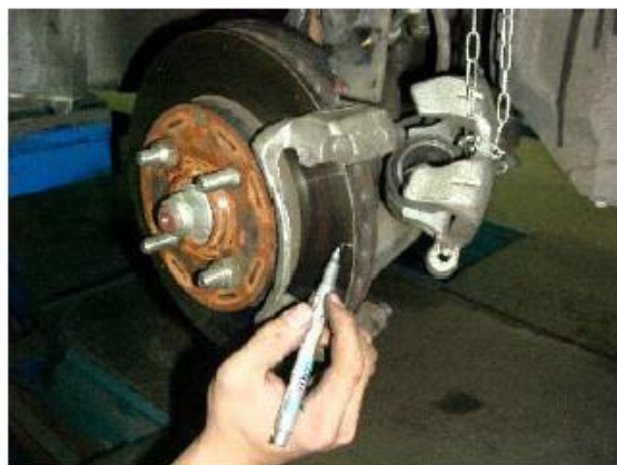
7. 碟盤厚度量測點記號
