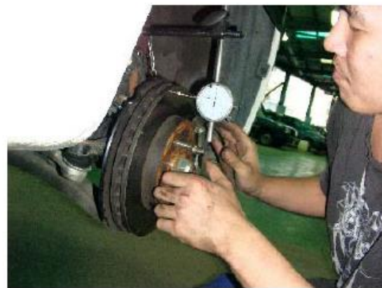
6 量測碟盤偏擺度
