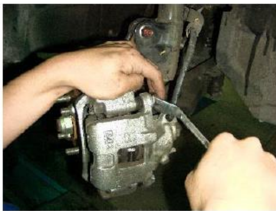
2 拆下煞車分泵固定螺絲
