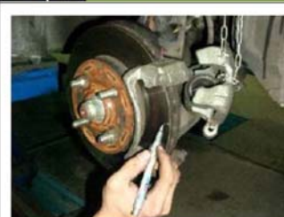
7. 碟盤厚度量測點記號
