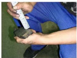
4 量測煞車塊厚度
