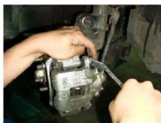
2 拆下煞車分泵固定螺絲
