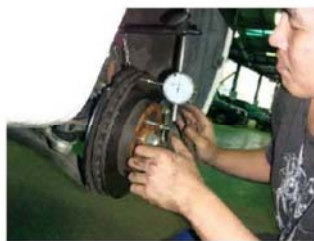
6 量測碟盤偏擺度
