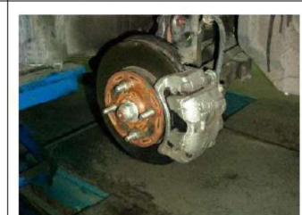
12. 完成碟式煞車檢修
