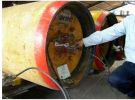
備註：需確認內存壓縮氣體  $P > 10 \text{ kg/cm}^2$  且  $V \geq 0.5 \text{ m}^3$  或 液化氣體  $P > 2 \text{ kg/cm}^2$  且  $V \geq 0.5 \text{ m}^3$  者
